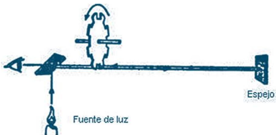
Dispositivo de Fizeau para medir la velocidad de la luz.
